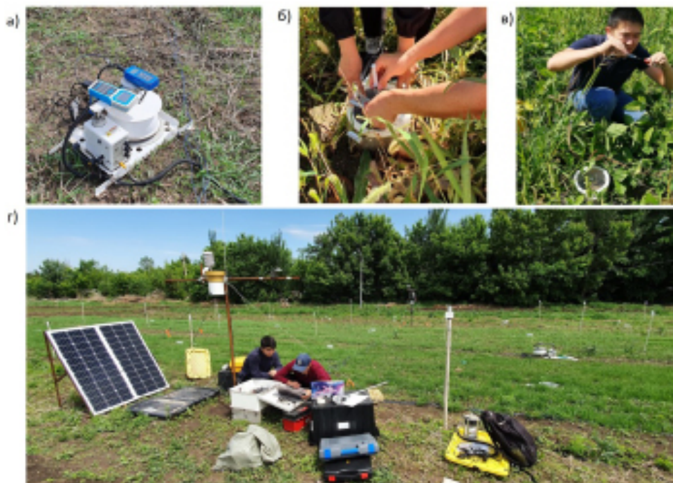
Рис. 4. Полевые работы по отбору проб почвенных выбросов ПГ: а) установленный на поле автоматизированный комплекс Li-Cor 8100; б) отбор образцов с помощью шприца; в) перемещение образца в вакутейнер; г) метеорологическая станция и почвенные кабели, подключенные к аккумулятору и солнечной панели.
