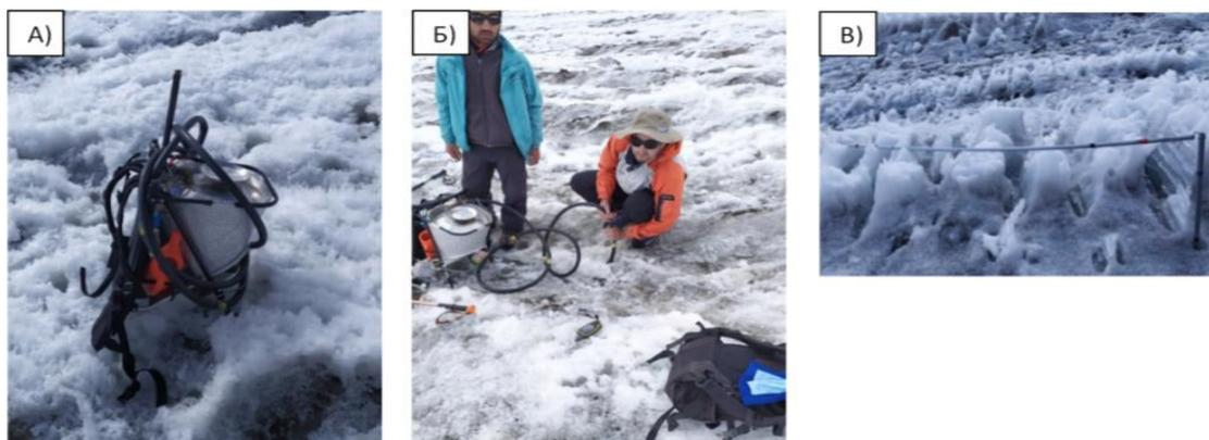
Рис. 6. Проведение полевых работ в зоне абляции: А) Паробур; Б) Установка реек; В) Рейка 2018 года
