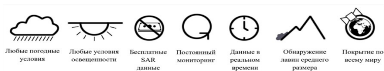
Рис. 1. Преимущества использования данных с радиолокационных космических спутников группировки Sentinel-1 для обнаружения лавин (Leinss et al., 2020)
