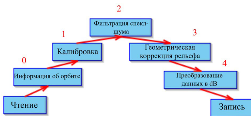
Рис. 5. Граф обработки снимков Sentinel-1 в программном обеспечении SNAP
